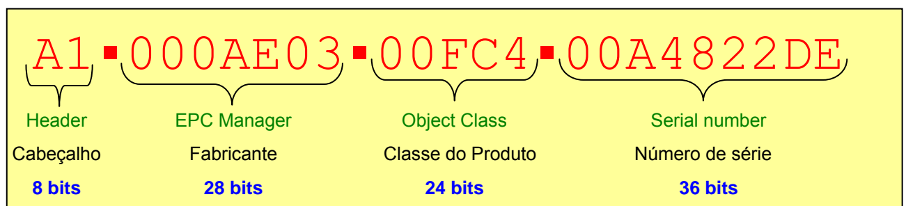
Figura 17 – Estrutura típica de um código eletrônico de produto (EPC).
